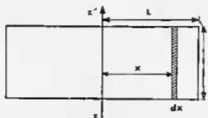
FIG. 44. — Moment d'inertie d'une bande élémentaire  $dx$  par rapport à un axe  $xz'$ .
